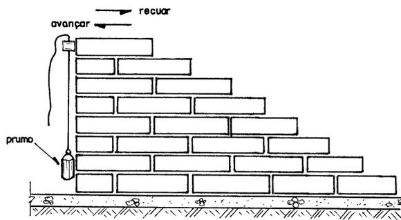
**Figura 6 - Detalhe do prumo das alvenarias.**
