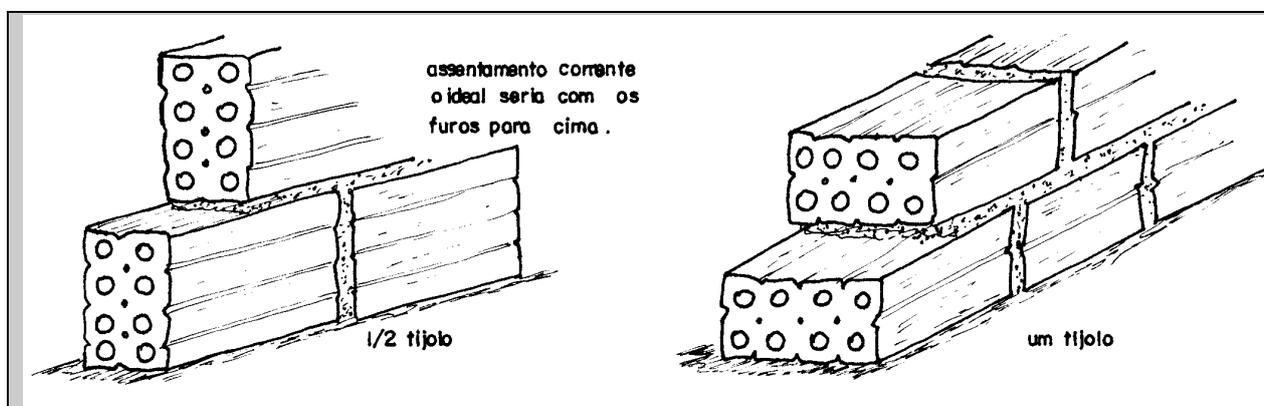
Figura 1 - Execução de alvenaria utilizando tijolos furados.
